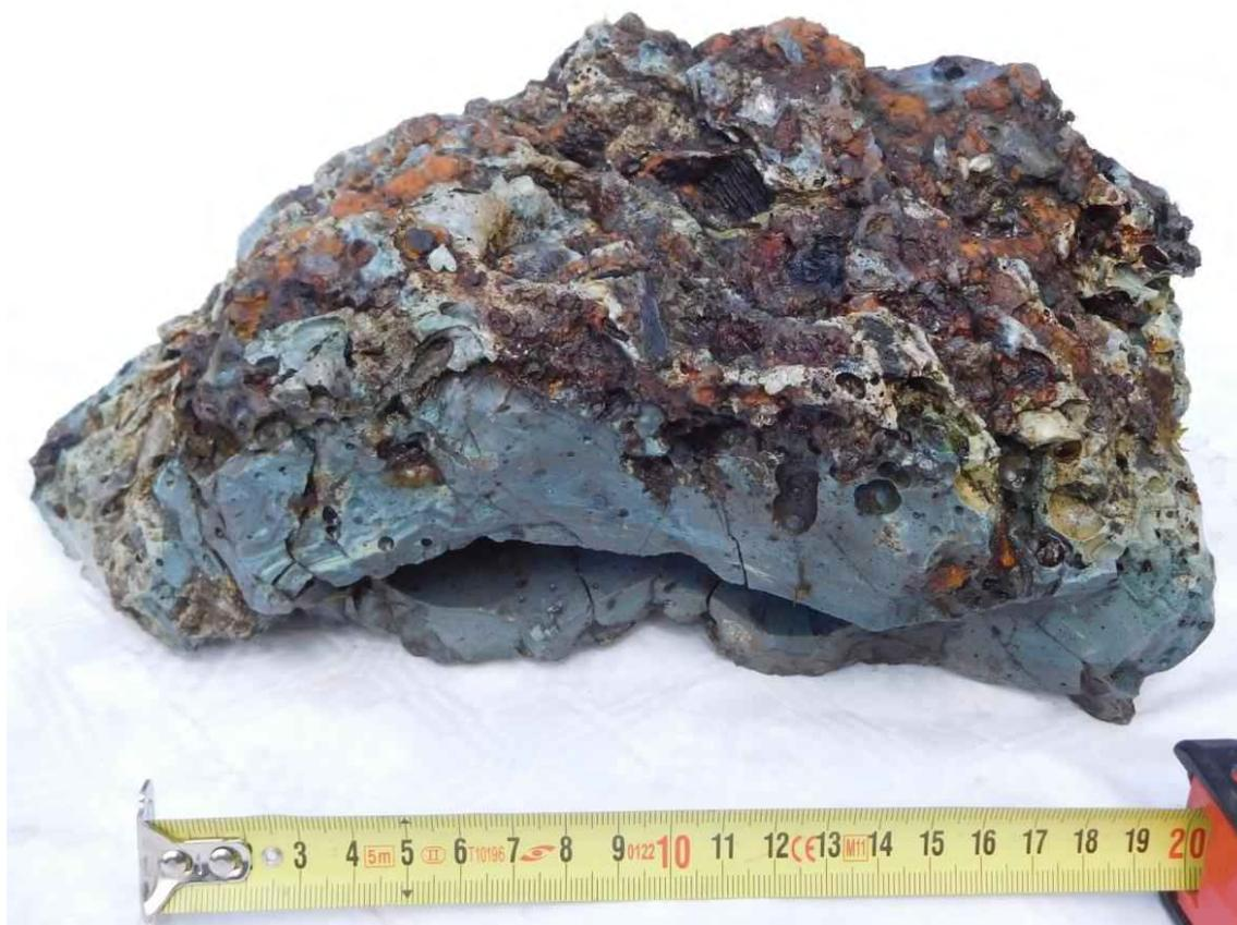
Fig. 8. Scorie bleutée de très grande dimension, avec inclusions de charbon de bois encore présentes, oxyde de fer en surface, conglomérats métalliques à certains endroits, gangue vitreuse et restes calcaires, ancienne forge de Crupet.
