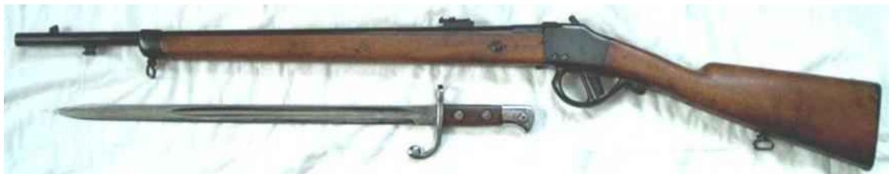
Fig. 5. Carabine Comblain mod. 1888, calibre 11x43R, longueur totale 1,032 m, produite de 1888 à 1896. © [www.littlegun.be](http://www.littlegun.be).
